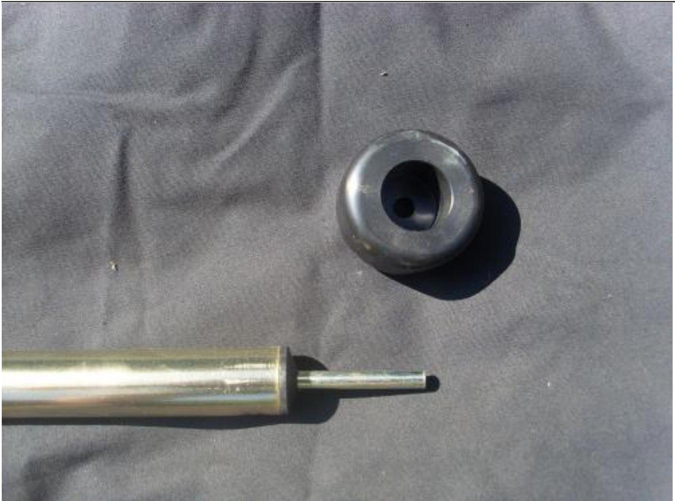
Optional kannst du nun noch eine [Schutzkappe](#) [39] aufsetzen. Diese hat den Vorteil, dass dein Jurtendach, bzw. die Ösen darin höhere Kräfte aufnehmen können. Das ist vor allem bei stürmischem Wetter sinnvoll.
