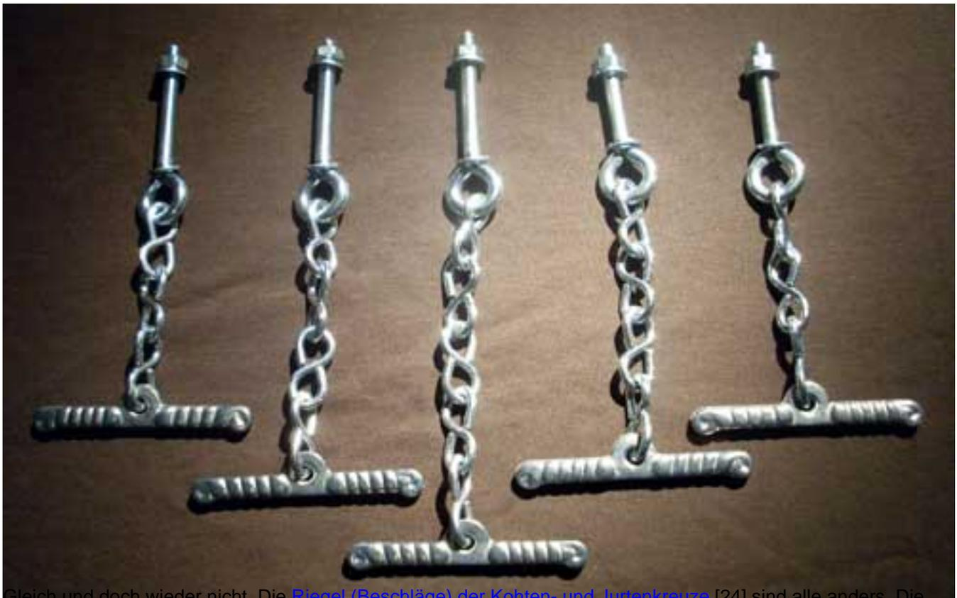
Gleich und doch wieder nicht. Die [Riegel \(Beschläge\) der Kohten- und Jurtenkreuze](#) [24] sind alle anders. Die Funktion jedoch ist immer die gleiche. Die Schrauben oben im Bild sind fest mit dem Kohtenkreuz verschraubt.
