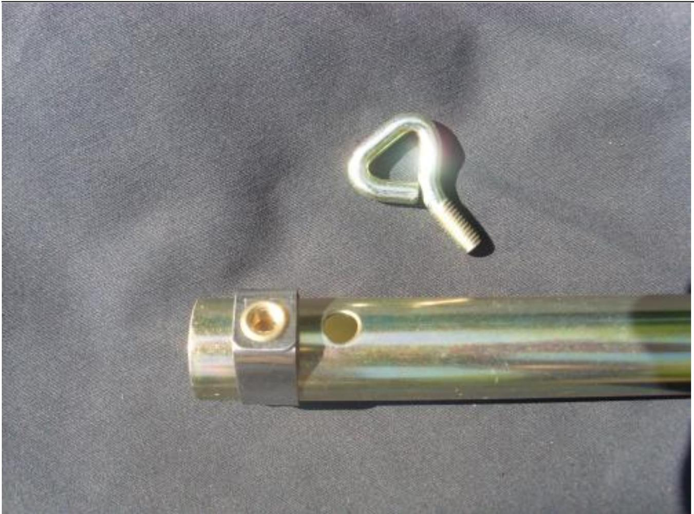
Die Rohrschelle wird auf das dickere Stangenende mit Loch aufgeschoben. In der Rohrschelle ist das Gewinde für die Herzschaube, mit der du die Teleskopstange in einer beliebigen Höhe fixieren kannst. Früher war dieses Gewinde direkt in das Rohr eingepresst. War dies einmal kaputt, so konnte es nicht wieder repariert werden. Heute musst du einfach die Rohrschelle auswechseln.
