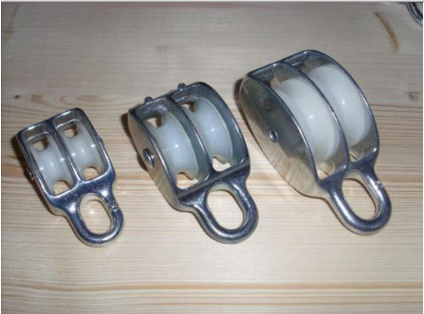
Ebenfalls unterscheiden sich die Blockseilrollen, ob sie 1-rollig oder 2-rollig aufgebaut sind. Was du brauchst hängt vom Anwendungsfall ab. Aus den verschiedenen Rollen lassen sich auch provisorische Flaschenzüge bauen. Bei größeren Jurtenkonstruktionen spart dies ebenfalls wieder Kräfte.
