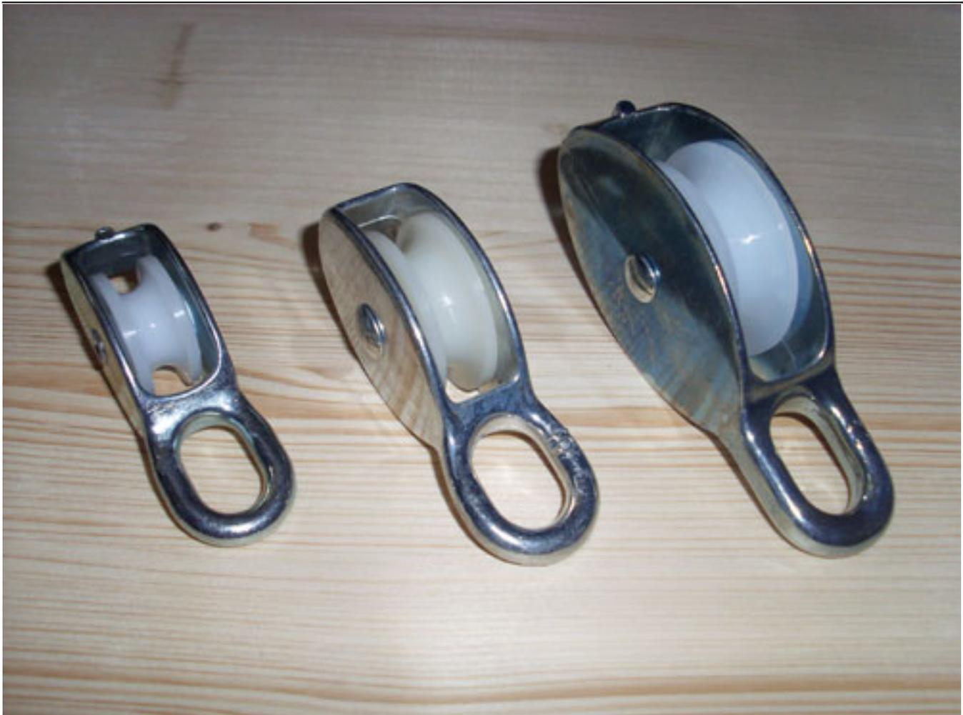
Ist die Blockseilrolle zu groß, oder das Seil zu dünn, dann besteht die Gefahr, dass das Seil von der Rolle springt und sich zwischen dieser und dem Gehäuse verklemmt. Auch dies tut dem Seil nicht gut. Wir verwenden z.B. für eine Kunsthanfseil mit 8 mm Durchmesser die 40er Blockseilrollen. Deren Rolle ist für Seile bis 9 mm geeignet. Sowohl Seil und auch Rolle sind für die Belastungen im Jurtenbau ausreichend (Seil bis ca 500 kg, Rolle bis ca. 300 kg).
