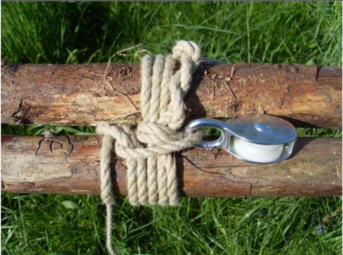
Der fertige Parallelbund verbindet die beiden Stangen sehr zuverlässig und rutscht auch nicht mehr ab. Insbesondere, wenn die Stangen verdreht werden, dann spannt sich der Bund selbst. Trotzdem ist der Parallelbund sehr flexibel und die Stangen können bis zu einem Winkel von 90 Grad gegeneinander verstellt werden. Dies ist die Voraussetzung, um diesen Bund für Kohten- und Jurtenstangen verwenden zu können.
